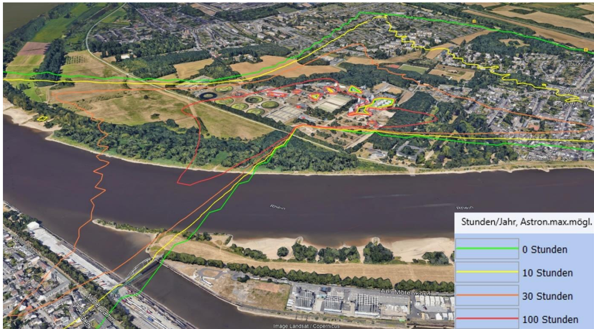
Abbildung 7: Schattenwurfprognose Nordex N117 für potenziellen Anlagenstandort (Entwurf, prognostiziert mit windPRO)
