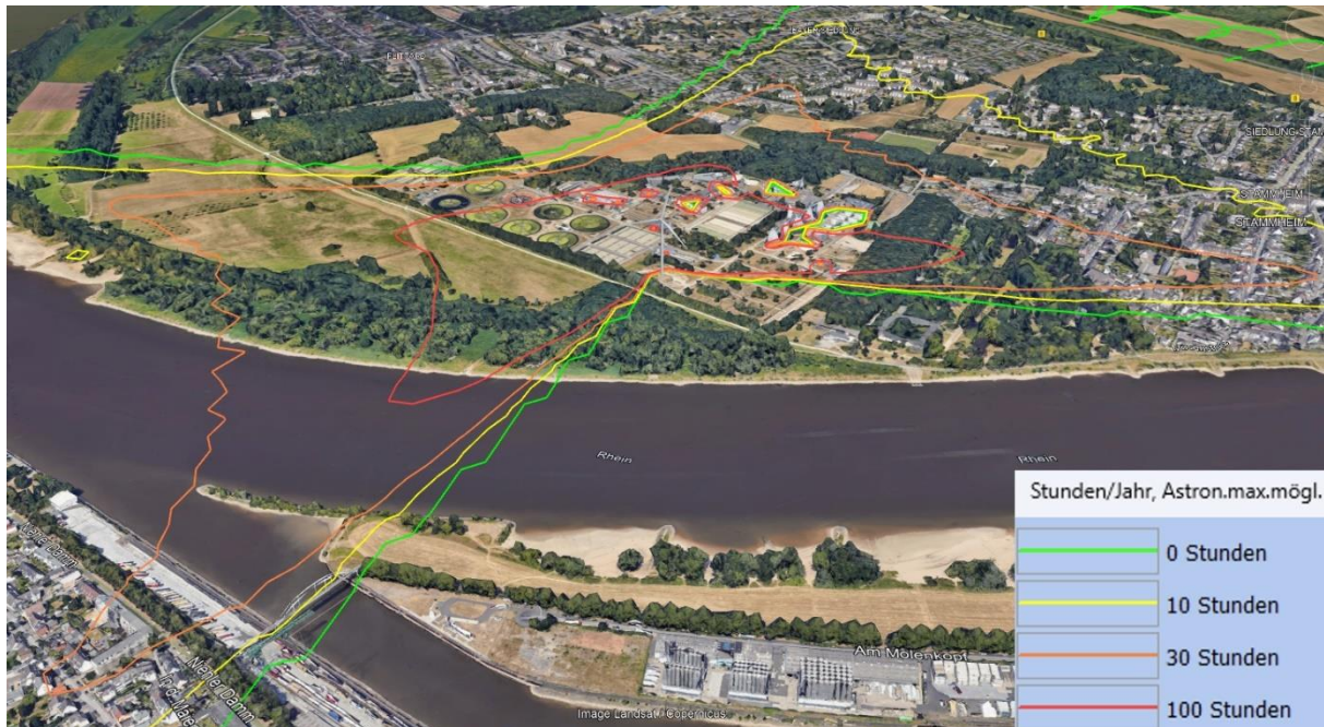
Abbildung 8: Schattenwurfprognose Vensys V115 für potenziellen Anlagenstandort (Entwurf, prognostiziert mit windPRO)
