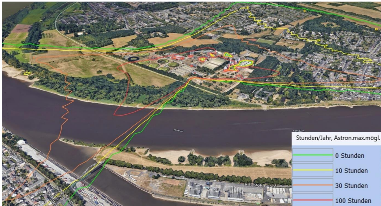
Abbildung 6: Schattenwurfprognose E115 für potenziellen Anlagenstandort (Entwurf, prognostiziert mit windPRO)
