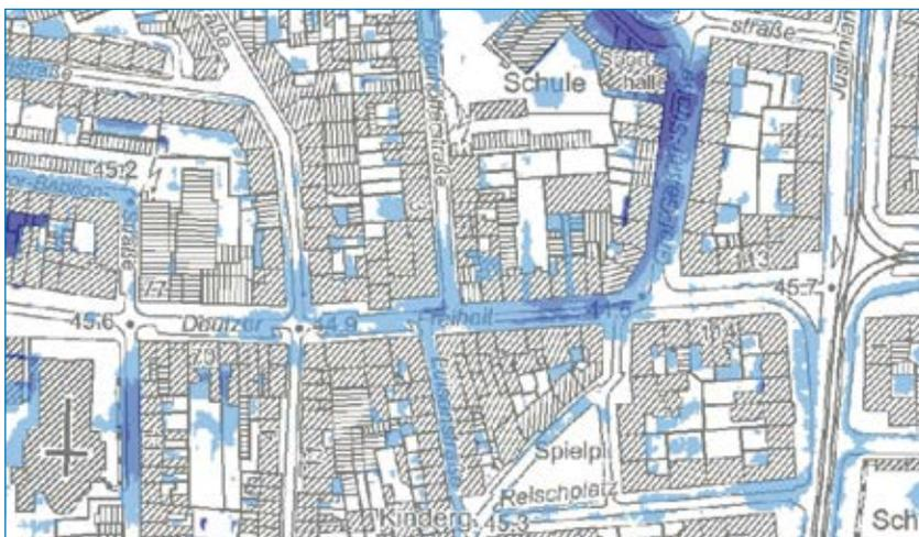
Abb. 8 – Ausschnitt aus der Starkregengefahrenkarte für Köln (SRI 7)
