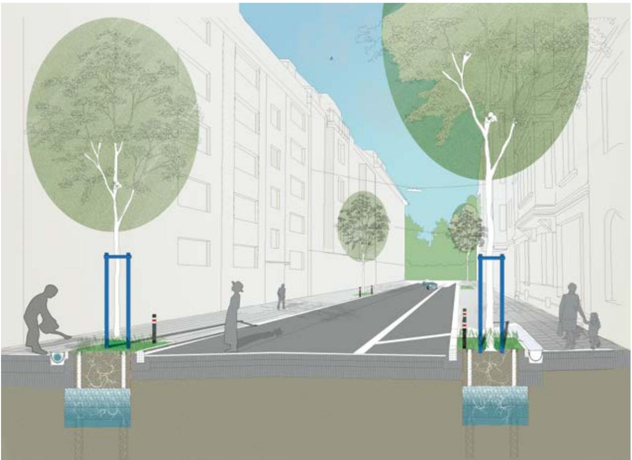
Abb. 28 – Pflanzgrube mit erweitertem Speichervermögen
