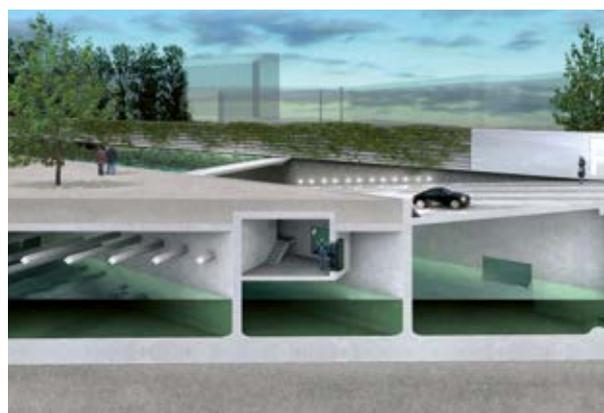
Abb. 44 – Querschnitt durch Tiefgarage mit Retentionsfunktion
