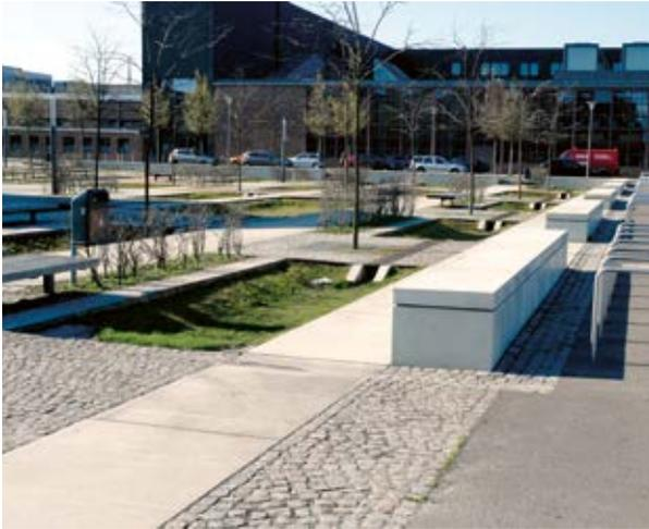
Abb. 18 – Beispiel für in die Platzgestaltung integrierte Retentionsflächen
