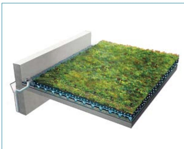
Abb. 47 – Funktionsprinzip eines Retentions Gründaches
