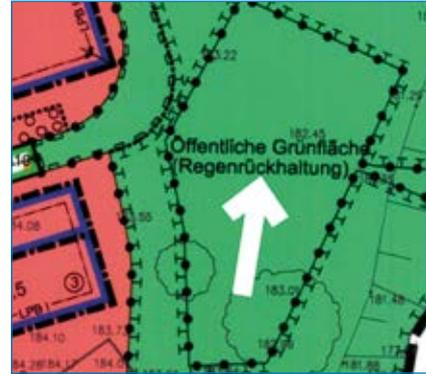
Abb. 61 – Temporäre Einbeziehung einer Grünfläche zur Regenrückhaltung
