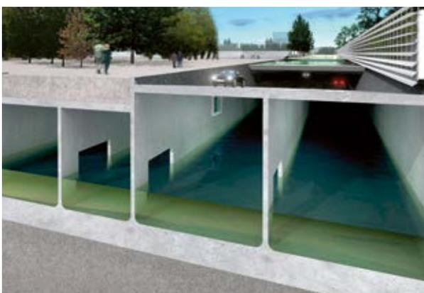
Abb. 43 – Nutzung der Lufträume unter der Rampe einer Tiefgarage zum Rückhalt von Abflussspitzen
