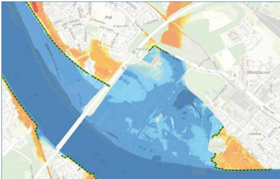
Abb. 11 – Ausschnitt aus der Hochwassergefahrenkarte für den Rhein (Poll und Westhoven mit der Westhovener Aue; mittleres Hochwasserereignis)
