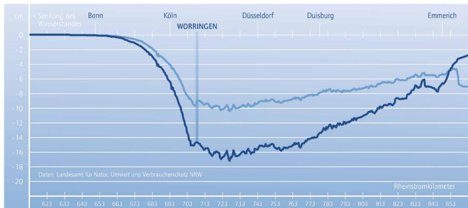
Wirkung des Retentionsraumes auf den Wasserstand bei verschiedenen Hochwasserwellen eines seltenen Hochwassers.
