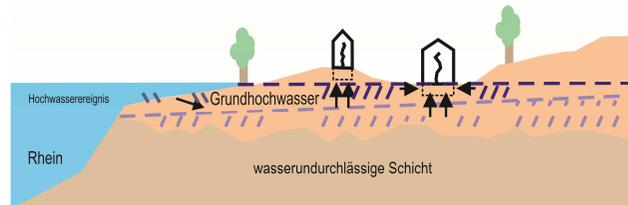
Durch ein Hochwasserereignis ändert sich die Fließrichtung zum Land hin und das Grundwasser steigt an.
