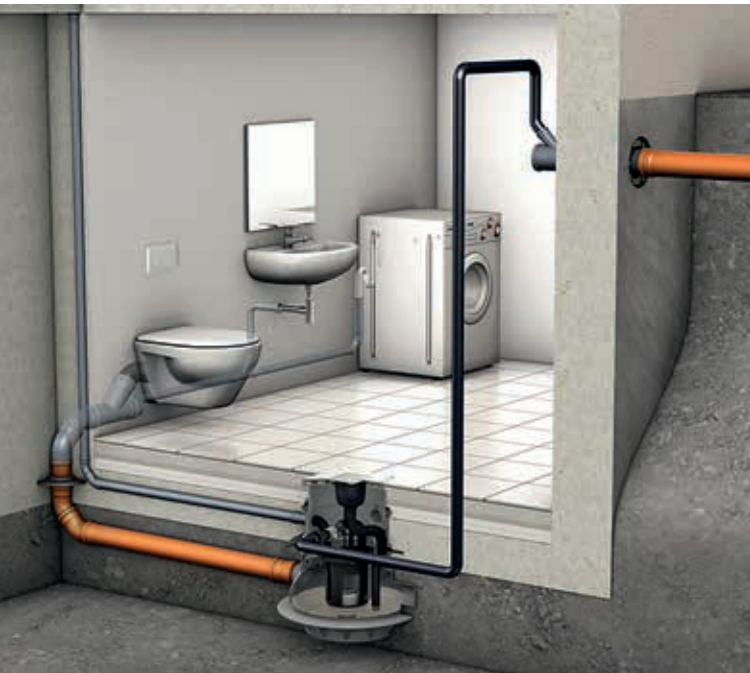
Abb. 41 – Funktionsprinzip einer Hebeanlage
