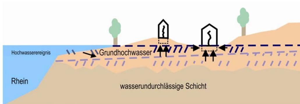
Durch ein Hochwasserereignis ändert sich die Fließrichtung zum Land hin und das Grundwasser steigt an.
