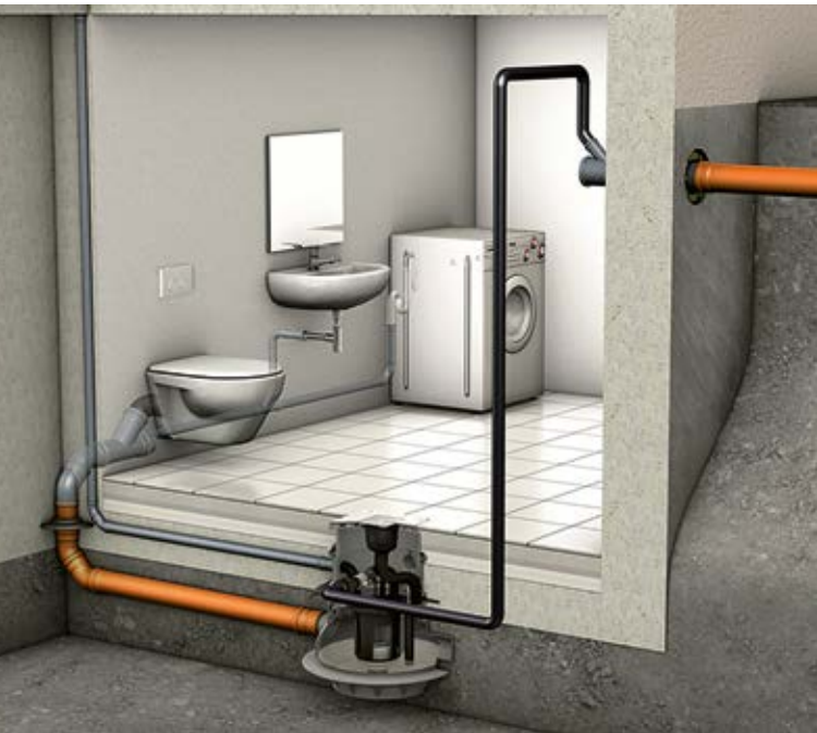
Abb. 41 – Funktionsprinzip einer Hebeanlage
