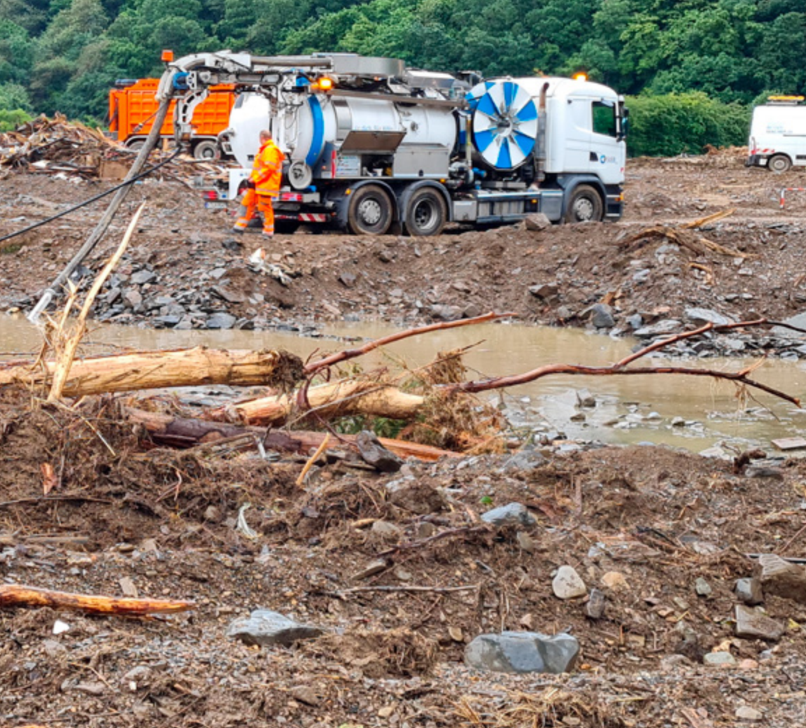
Ein Kanalreinigungsfahrzeugen mit Wasserrückgewinnung im Einsatz im Überflutungsgebiet.
