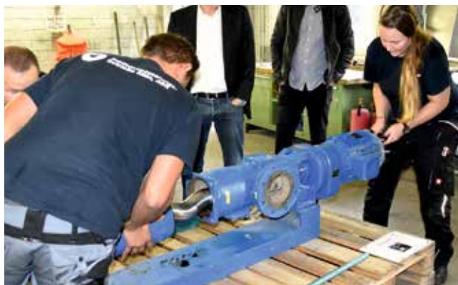
Auszubildende beim Statorwechsel im neuen Ausbildungszentrum
