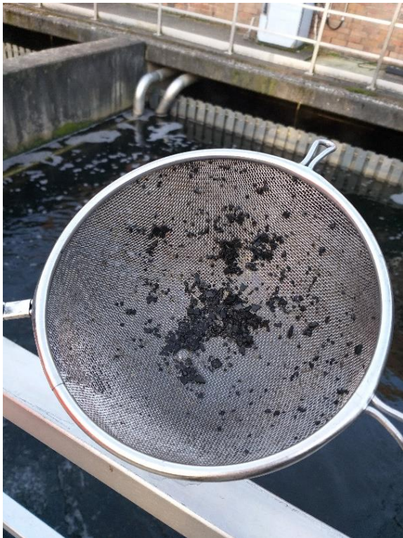
Bild 74: Sieb mit Aktivkohle vor Einbau der Entlüftungsleitung
