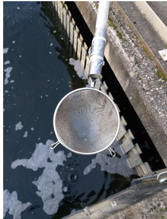
Bild 75: Sieb ohne Aktivkohle nach Einbau der Entlüftungsleitung
